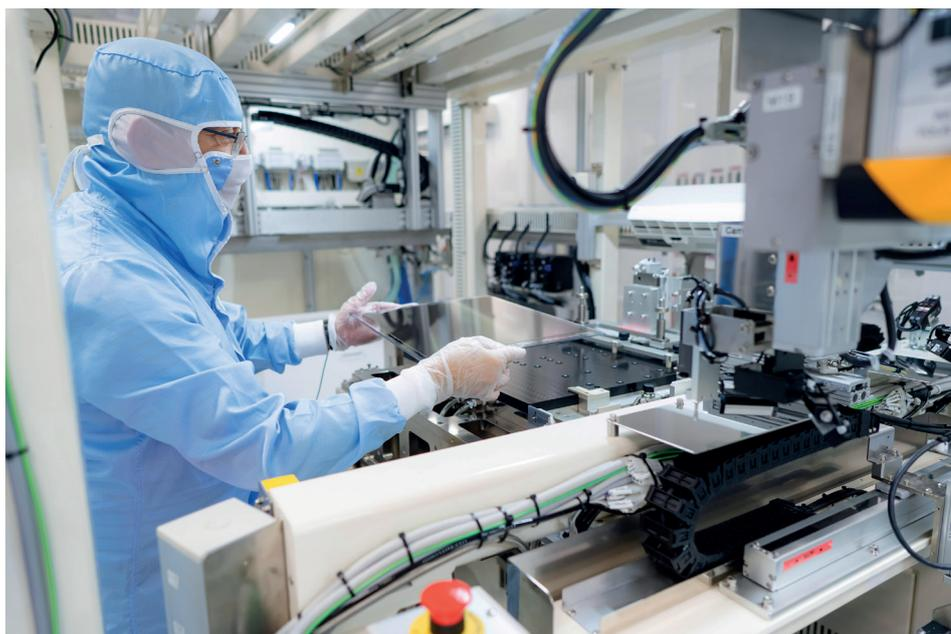
*Le couplage des éléments d'un détecteur.*
